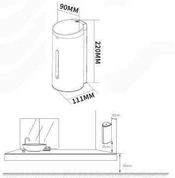
NOTA: se la superficie sottostante è in acciaio, la distanza dal sensore dev'essere di almeno 35 cm.
