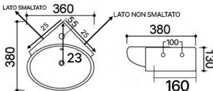
*Il lato d'appoggio al muro per l'installazione non è smaltato*
