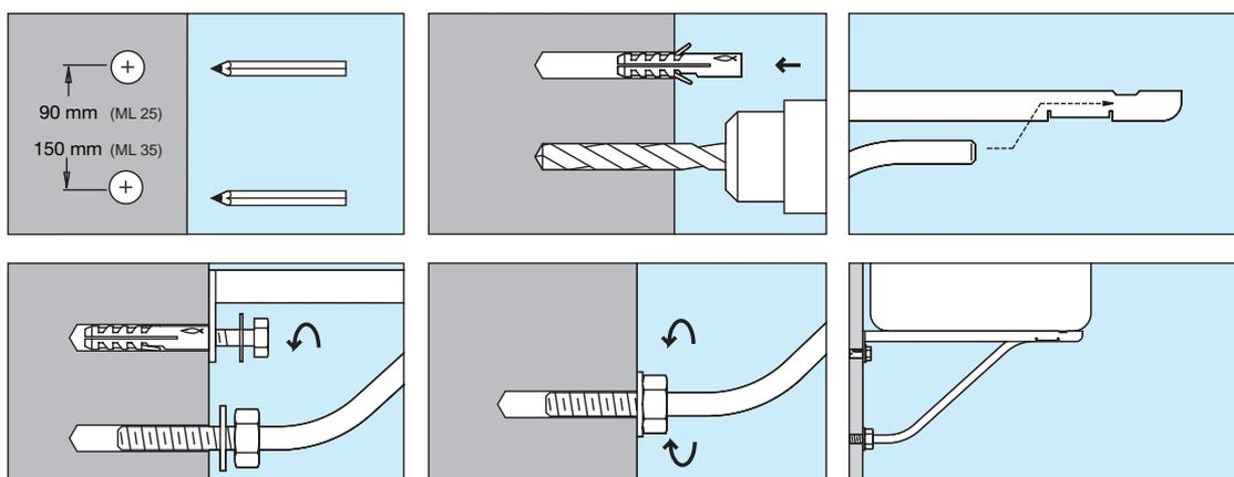
Si raccomanda un'accurata pulizia del foro prima dell'installazione.
