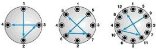
Corretta sequenza di serraggio
