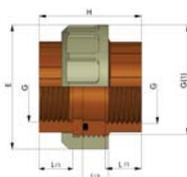
**BOCCHETTONE con ghiera filettata GAS - estremità femmina filettata G con guarnizione O-ring in NBR**
