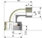
MEZZO RACCORDO a GOMITO a 90° RIDOTTO F/M in PA ghiera mobile, guarnizione in EPDM
