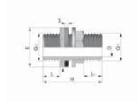
ATTACCO PER SERBATOIO MM estremità maschio filettata G1 ed una m unita di COLLARE di serraggio e GUARNIZIONE piana\* in EPDM
