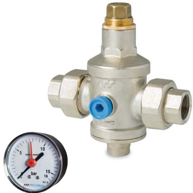
Il riduttore di pressione PESANTE è indicato particolarmente in impianti, sia civili che industriali, in cui si richiedono portate medio-alte, con la garanzia, inoltre, della sede di tenuta in acciaio inossidabile. Caratteristica principale è il funzionamento a pistone con camera di compensazione.
