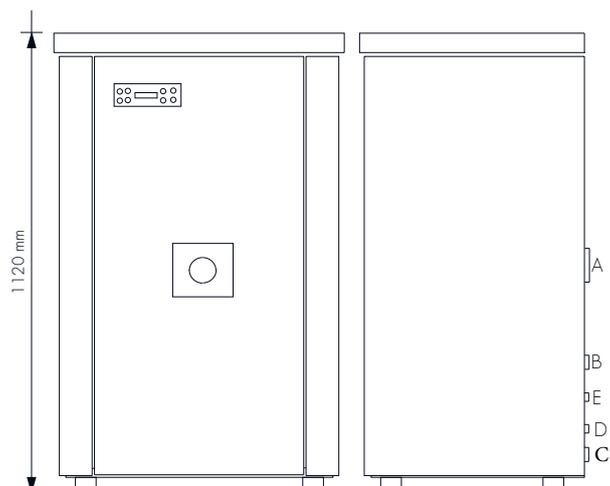
Le Biocaldaie Enea a pellet Dianflex sono semplicissime da installare, basta collegarle agli impianti dell'abitazione, ad una presa di corrente elettrica e ad una canna fumaria dal diametro di soli 80 mm in conformità a quanto prescritto dalla norma UNI 10683 del 2005. Inoltre il pratico sistema di apertura dei fianchi (senza l'ausilio di alcun attrezzo) facilita e riduce i tempi della manutenzione straordinaria.
