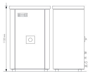
Le Biocaldaie Enea a pellet Dianflex sono semplicissime da installare, basta collegarle agli impianti dell'abitazione, ad una presa di corrente elettrica e ad una canna fumaria dal diametro di soli 80 mm in conformità a quanto prescritto dalla norma UNI 10683 del 2005.
