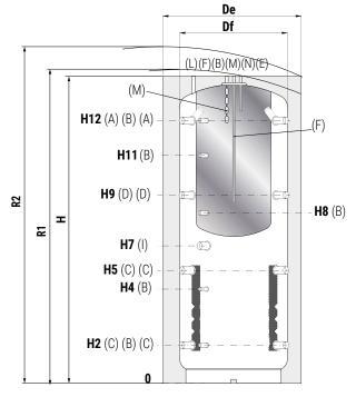
Mandata riscaldamento/dal generatore 1"1/2 Gas F Α В Connessione per strumentazione 1/2" Gas F С Ritorno riscaldamento/al generatore 1"1/2 Gas F D Mandata riscaldamento 1"1/2 Gas F Ε Uscita acqua calda sanitaria 3/4" Gas F F Ingresso acqua sanitaria 3/4" Gas F Connessione per integrazione elettrica 1"1/2 Gas F Sfiato 1/2" Gas F Anodo di magnesio 3/4" Gas F Ricircolo 3/4" Gas F
