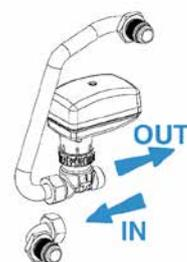
**Pompa scarico condensa**
