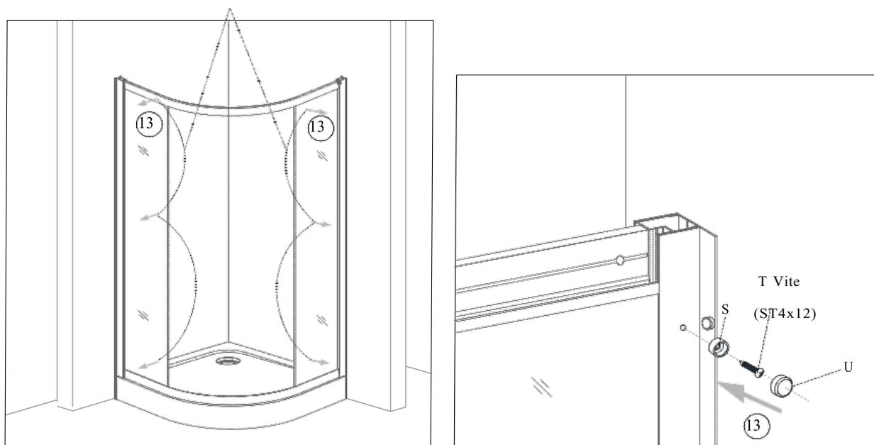
Fissare la cornice nelle barre a parete con viti (ST4x12) e guarnizioni (S), e ultimare con tappo (U)
