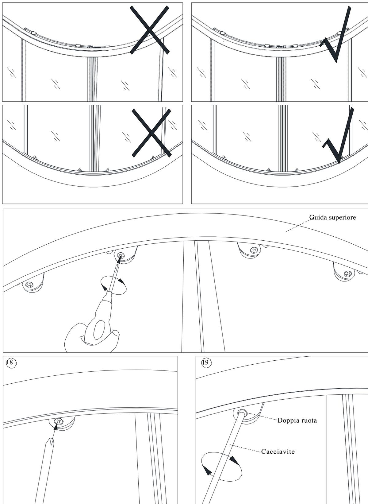
Appoggiare le rotelle sulla barra guida di alluminio, e regolare le viti sulla doppia ruota per allineare le pareti scorrevoli. Può regolare tranquillamente le viti con un cacciavite in modo da far chiudere perfettamente i vetri scorrevoli tra di loro.
