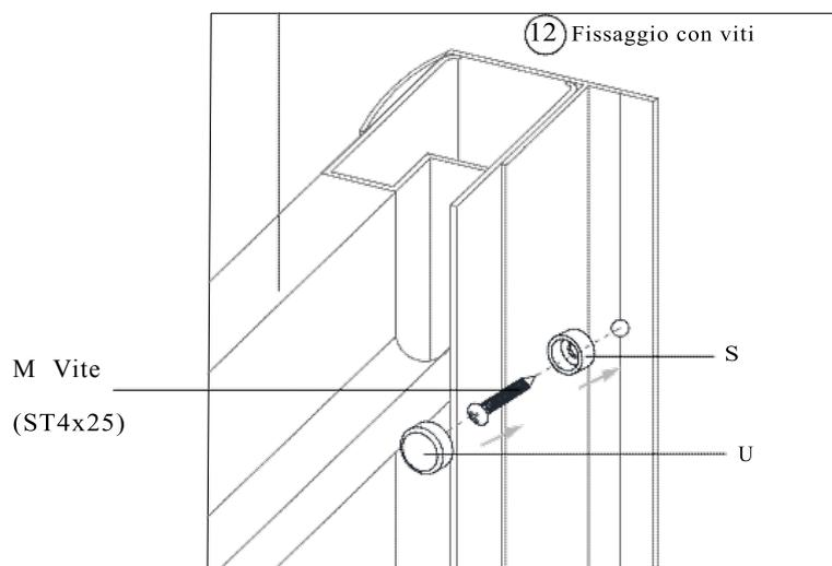
Ancorare le barre alla parete, avendo cura di fissare con le apposite viti (ST4x25). Allontanate il box doccia in modo tale da poter lavorare comodamente.
