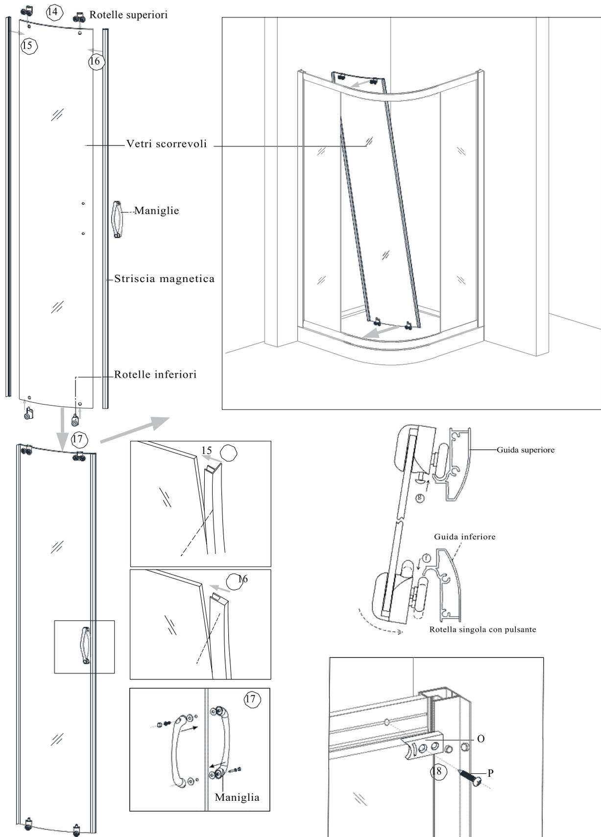
Fissare le ruote sul vetro scorrevole e coprire con l'apposito tappo dopo aver allineato. Sistemare la guarnizione impermeabile e la striscia magnetica.
