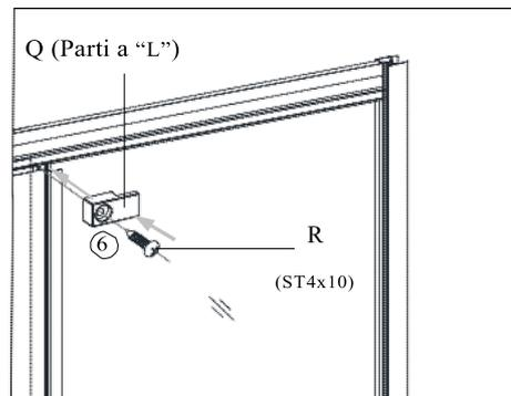
Fissare le cornice e le guide con viti K(ST4\*25). Successivamente inserire il gommino a "U" sul vetro fisso e fissare nella cornice. Avvitare le parti a "L" per bloccare.
