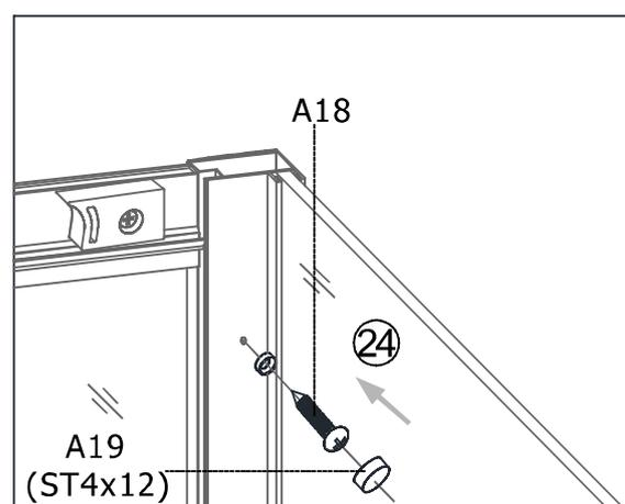
L'installazione delle pareti laterali segue passo passo l'installazione del modulo a "I" avendo cura di integrare successivamente con le opportune pareti laterali a destra o a sinistra. Le pareti laterali vanno assemblate avendo cura di inserire la comma "U" (A3) sui bordi, e successivamente inserire i profili in alluminio (C1). I profili in alluminio B1 e B2 sono i profili esterni, quindi vanno montati sul perimetro della parete a "L".
