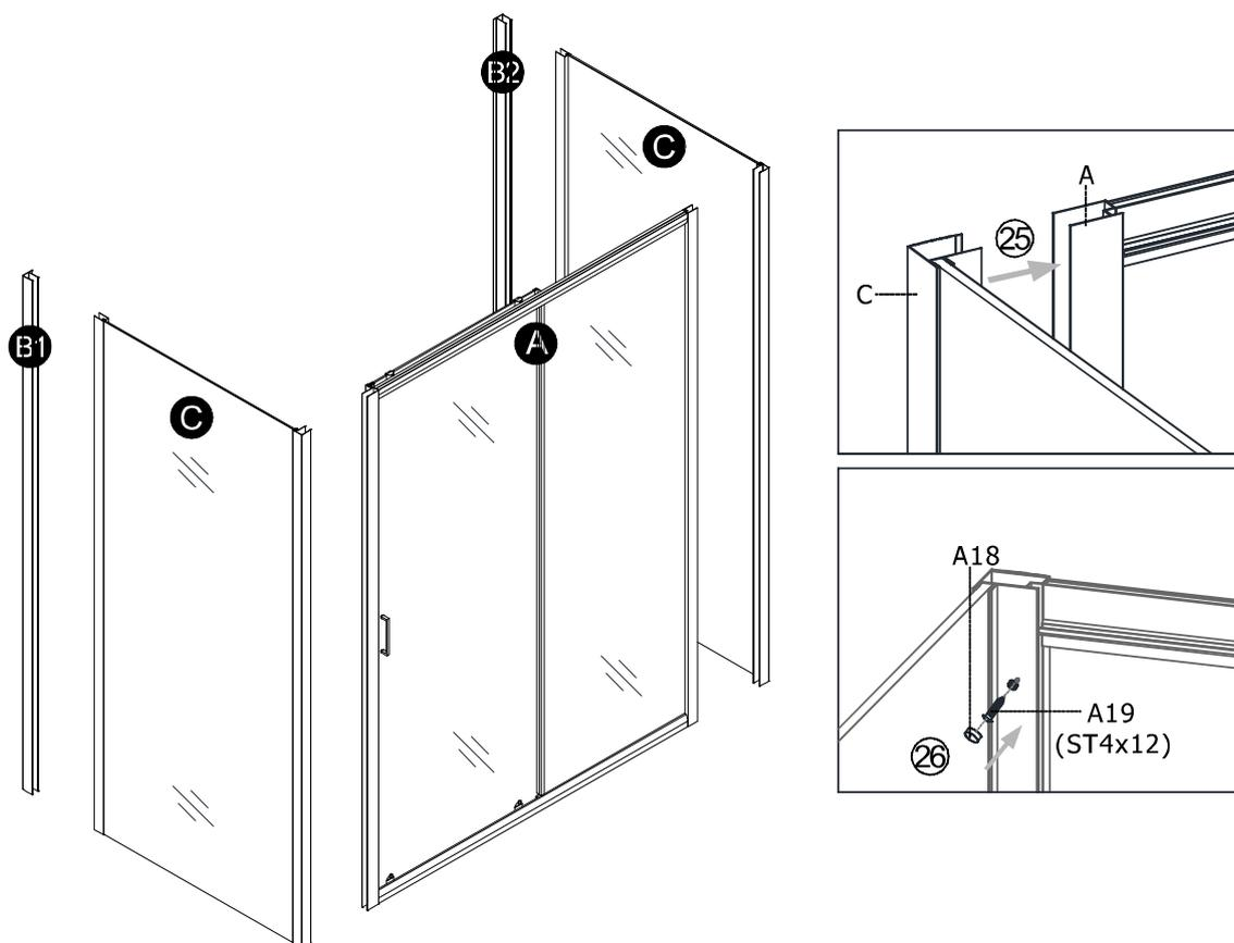
L'installazione delle pareti laterali segue passo passo l'installazione del modulo a "I" avendo cura di integrare successivamente con le opportune pareti laterali a destra e a sinistra. Le pareti laterali vanno assemblate avendo cura di inserire la comma a "U" (A3) sui bordi, e successivamente inserire i profili in alluminio (C1). I profili in alluminio B1 e B2 sono i profili esterni, quindi vanno montati sul perimetro della parete a "U".
