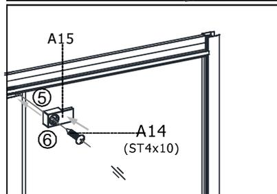
Fissare i profili in alluminio verticali e orizzontali con la vite A11. Inserire la gomma a "U" (A3) sul bordo della parte fissa ed inserirla nel profilo in alluminio. Bloccare la parete fissa con le apposite parti ad "L" (A15) e le viti dedicate (A14).
