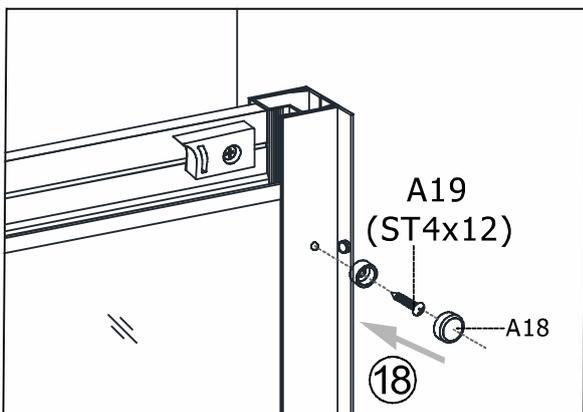
Riprendere lo schermo doccia e inserirlo nei profili a muro avendo cura di fissarlo con le apposite viti (A19) e coprire la vite con l'apposito tappo (A18)
