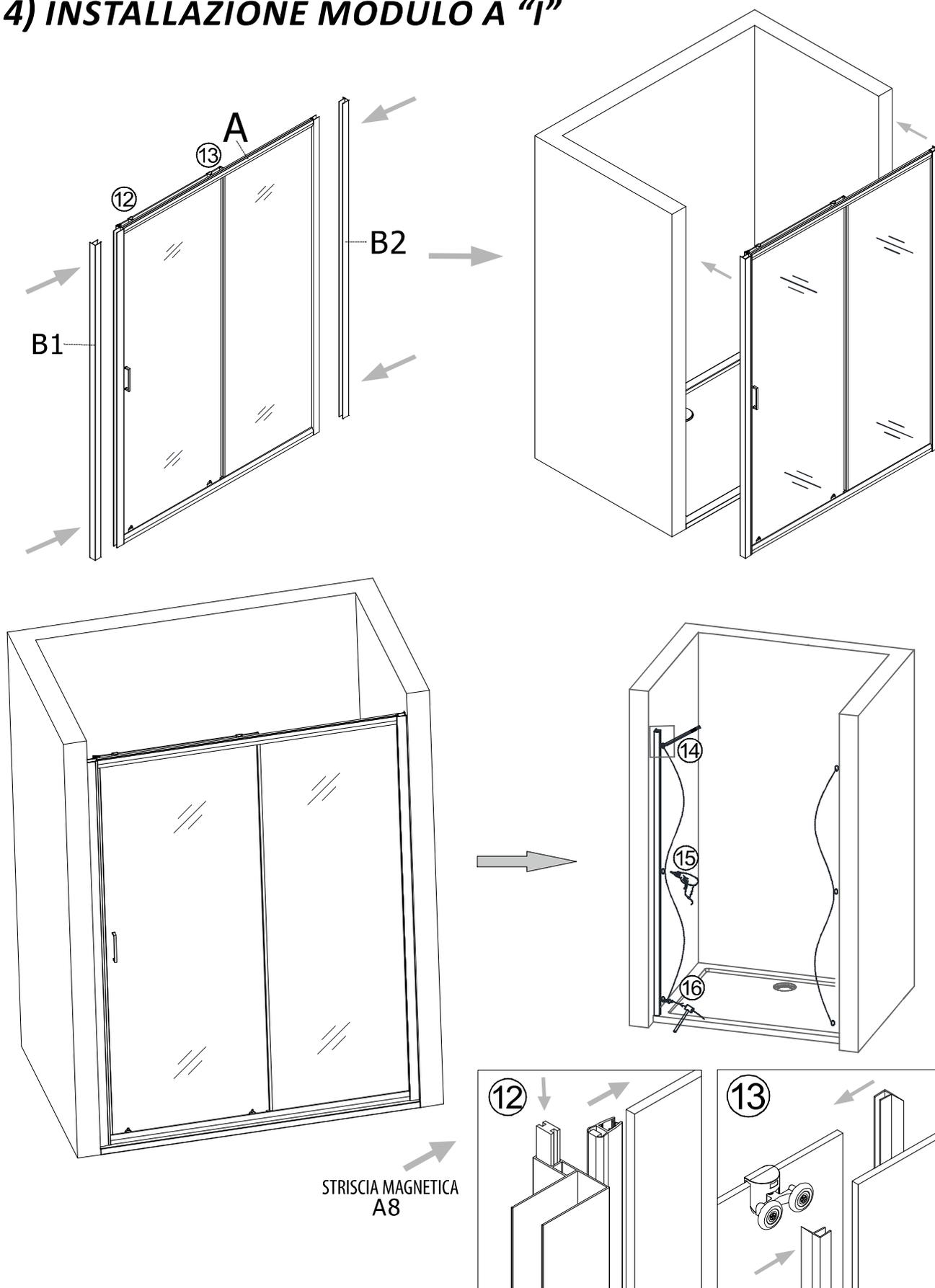
Inserire i profili in alluminio B1 e B2 sui due lati dello schermo doccia. Posizionarli accuratamente dove desiderato. Segnare la posizione sul muro. Rimuovere lo schermo doccia e adagiarlo attentamente in una posizione sicura. Praticare i fori per fissare i profili B1eB2 al muro nella posizione desiderata utilizzando le viti di fissaggio ST4x25.
