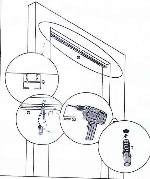
**3** Posizionare la guida superiore "G" sull'architrave e fissarla con una sola vite, esclusivamente nella parte centrale, quindi ruotarla in modo perpendicolare al vano.
