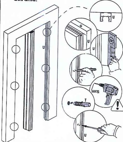
**7** Inserire ad incastro il profilo attacco anta (B) nel profilo laterale (U) sul lato opposto all'apertura. Iniziando dalla parte superiore, esercitare la pressione necessaria a sentire lo scatto d'inserimento, procedere quindi per l'intera lunghezza del profilo. Completata questa operazione inserire ad incastro anche l'ultimo pannello dell'anta all'interno del profilo attacco anta.
