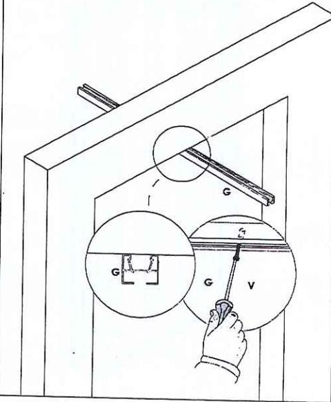
**4** Agganciare l'anta alla guida superiore, inserendo i supporti presenti sulla parte alta dell'anta all'interno della guida. Inserire l'anta con il profilo maniglia rivolto verso il lato in cui si vuole l'apertura della porta.
