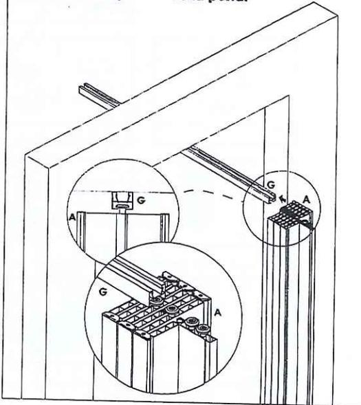
**5** Posizionare l'anta raggruppata al centro della guida superiore, quindi ruotare la guida e fissarla con le viti in dotazione nei fori fatti in precedenza.
