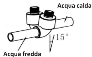
1. I due attacchi sono inclinati di 15° in direzioni diverse, in modo facilitare il collegamento dei tubi.
