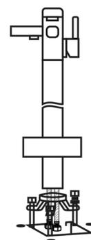
7. Fissare il miscelatore al pavimento con le apposite viti di fissaggio.
