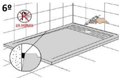
Sigillare la spazio tra il piatto e le pareti per evitare infiltrazione d'acqua. Aspettare almeno 24 ore prima di procedere con l'eventuale piastrelamento e installazioni di cabine doccia. / *Seal the space between the plate and the walls to avoid water infiltration. Wait at least 24 hours before proceeding with the actual tiling and installation of shower enclosures.*
