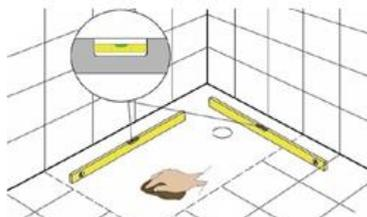
Assicurati che il luogo in cui verrà installato sia perfettamente liscio. *Make sure the place where it will be installed is perfectly smooth.*
