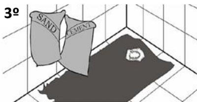
Mettere a livello, lasciando abbastanza spazio per l'impianto di scarico e sifone. Far asciugare completamente. *Level up, leaving enough room for the exhaust system and siphon. Allow it to rise completely.*
