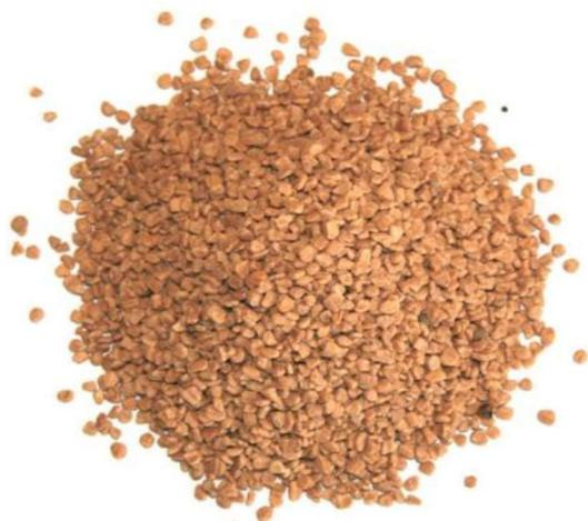
recuperare meccanicamente, mediante apposite macchine separatrici, la parte corrispondente ai frammenti di nocciolo dell'oliva, materiale che ben si presta ad un utilizzo come combustibile. Importante non confondere con nocciolino di sansa disoleata esausta, ottenuto mediante processi chimici che prevedono l'utilizzo di solventi per poter estrarre il cosiddetto "olio di sansa". Per un buon funzionamento della macchina, il nocciolino deve rispettare le seguenti caratteristiche:
