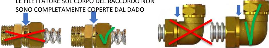
**ATTENZIONE:** quando si serrano i raccordi sui tubi di rame, prestare attenzione a non far ruotare il tubo di rame Ø22 del collettore. Se il tubo di rame viene ruotato, danneggerà l'assorbitore che si romperà alla saldatura fra i tubi verticali e il condotto di collezione Ø22. Si deve esercitare forza in senso contrario per evitare danni!
